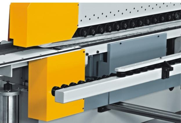
Barra de roldanas plásticas reforçadas, para apoio e contrapressão de painéis que recebem esforço lateral de pressão pelas fresas das tupias, especialmente quando da execução de perfis.
