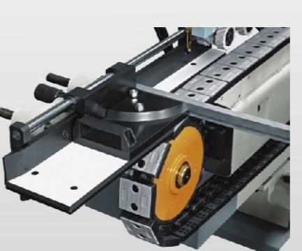
Composta por uma guia lateral de roldanas emborrachadas e um esquadro de apoio para permitir um perfeito alinhamento da peça na entrada.
