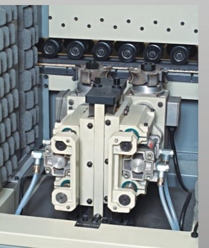
Utilizada para retificar as bordas dos painéis retos, utilizando fresas cilíndricas ou para executar perfis nas bordas de painéis. Composto de dois motores em posição vertical de 3 ou 5 CV 14.000 rpm, com sentido de rotação contrário um do outro para evitar de lascar as lâminas na entrada ou saída. Possuem dispositivo eletro pneumático para entrada e saída automática.
